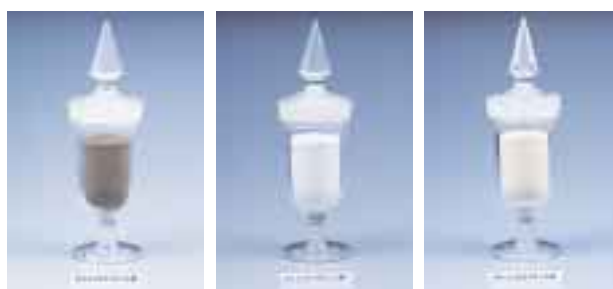
スーパーインテリジェント触媒の活性成分(左から、Pdインテリジェント材、Ptインテリジェント材、Rhインテリジェント材)
