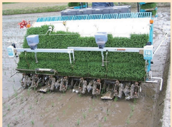
P14 写真1 左:側条施薬機を装着した移植機(円内は施薬ホッパー) 右:田植え同時施薬機
