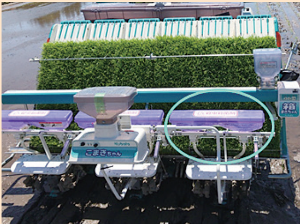
P14 写真1 左:側条施薬機を装着した移植機(円内は施薬ホッパー) 右:田植え同時施薬機
