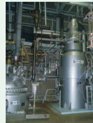
右が新たに導入した「高真空蒸留装置」
