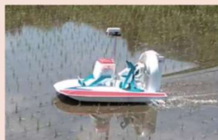
ラジコンボート(粒剤散布装置装着)
